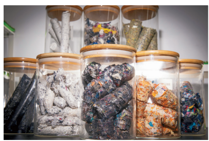
■當廢棄物經過破碎、分選、攪拌、成型後，就變成一根根或是一片片，燃燒效率與煤炭相同，但碳排量僅剩1/3的SRF。圖為SRF產品。
